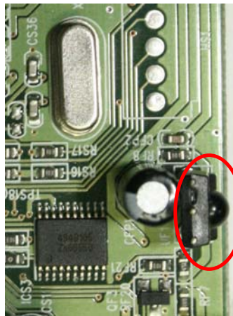
รูปที่ 2.7 แสดงภาพ ตัวรับสัญญาณอินฟราเรด 38 KHz (UF1)
